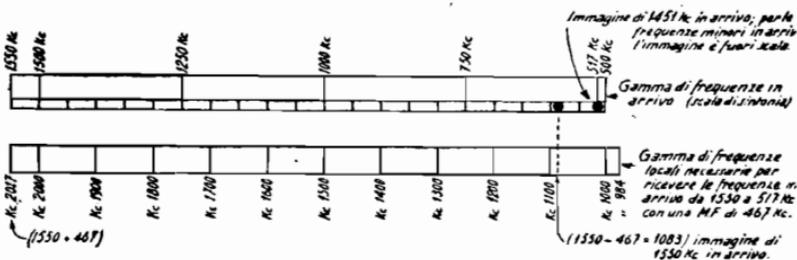
Fig. 5. - In quale posizione del quadrante si ricevono o si ricevirebbero le immagini delle frequenze estreme della gamma O.M., con una M.F. di 467 Kc e per una frequenza locale superiore a quella utile in arrivo. Come si vede le immagini delle frequenze in arrivo minori di 1451 Kc cadono fuori del quadrante.
