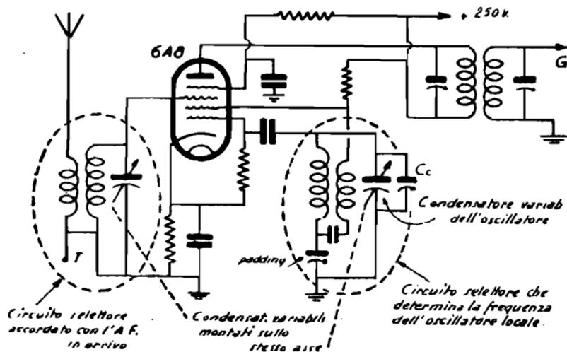
Fig. 1. - Stadio convertitore di una supereterodina con valvola oscillatrice-modulatrice (schema di principio).
