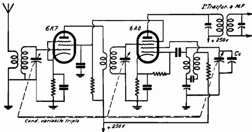
Fig. 2. - Supereterodina con stadio preamplificatore (schema di principio)
